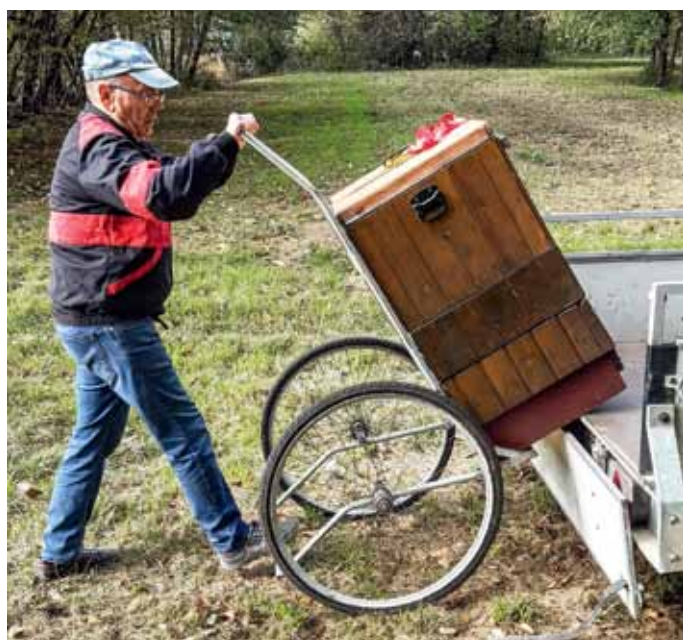
Rudlík s velkými koly usnadňuje manipulaci včetně nakládání i vysokých úlů
